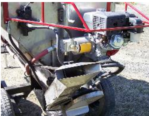
Fig. 4 – Système de soufflerie
